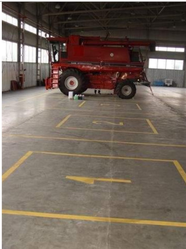
Фото 10. Разметка площадки для техники, находящейся в ремонте и техническом обслуживании обеспечивает рациональное использование площади мастерской и четкое управление процессом ремонта
